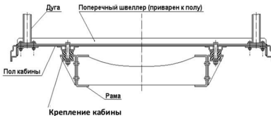
Рис. 3В-8 Опоры каркаса безопасности, установленные в кабине
