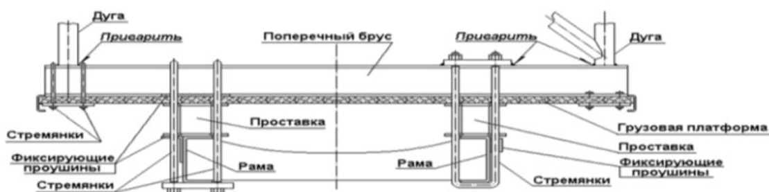
Рис. 3В-10 Опора главной дуги на грузовой платформе
